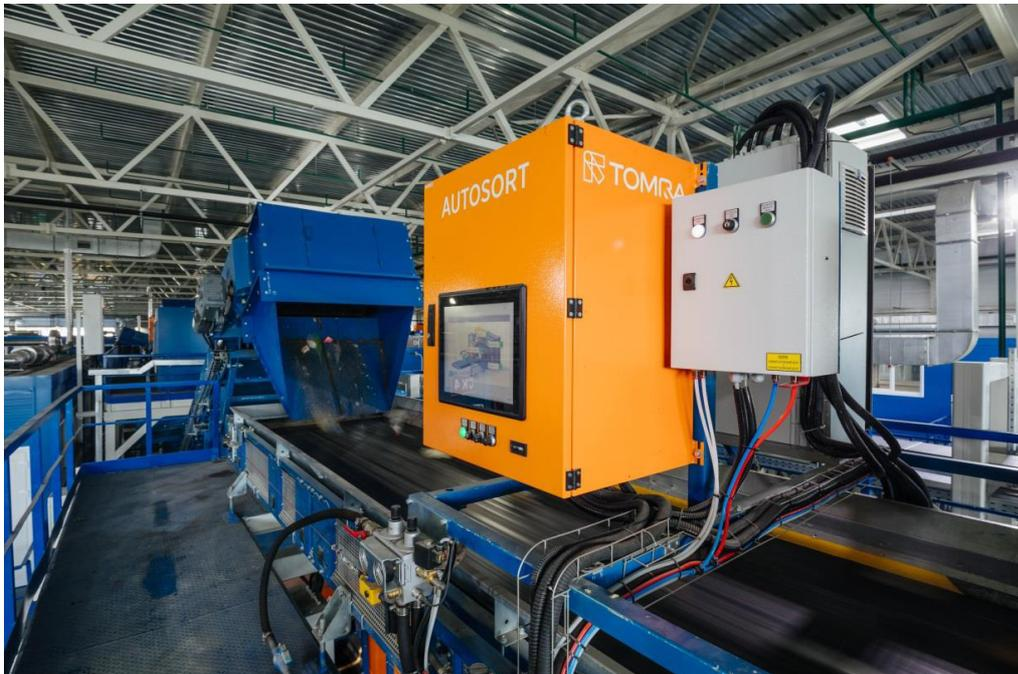
Рис. 15. Оптический сепаратор
