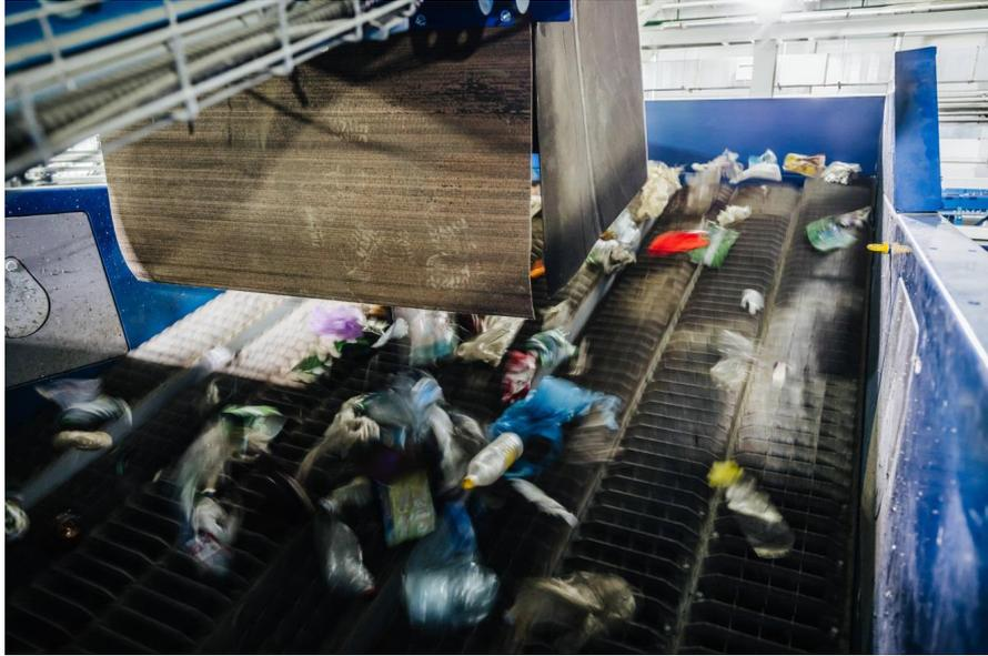
Рис. 16. Процесс баллистической сепарации
