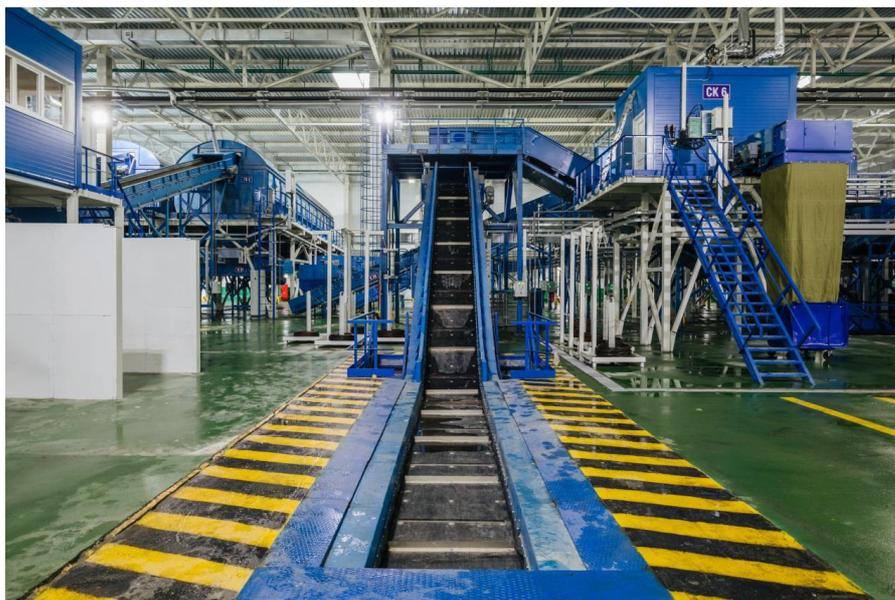
Рис. 17. Конвейер на участок прессования
